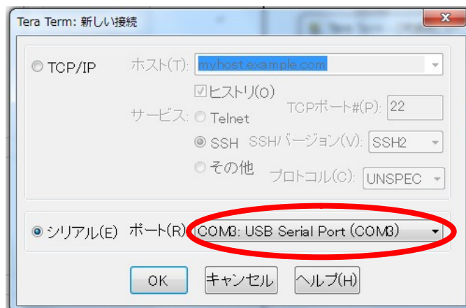
• TeraTerm の新しい接続画面 (2)で確認した COM3 を選択する ※ 環境により異なります
